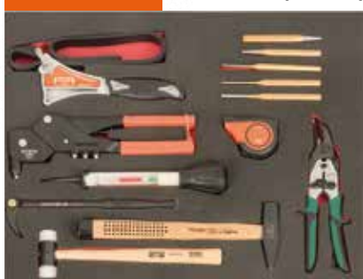
Martillos y botadores, tijera cortachapa, remachadora, flexómetro, palanca articulada, densímetro de baterías y llave de cinta
